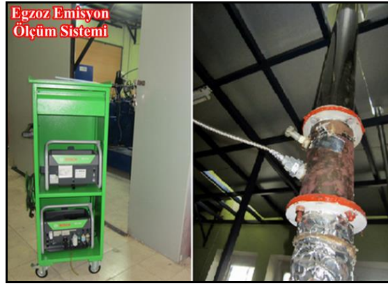
Şekil 7.2 Emisyon ölçüm cihazı ve prop-egzoz bağlantısı
